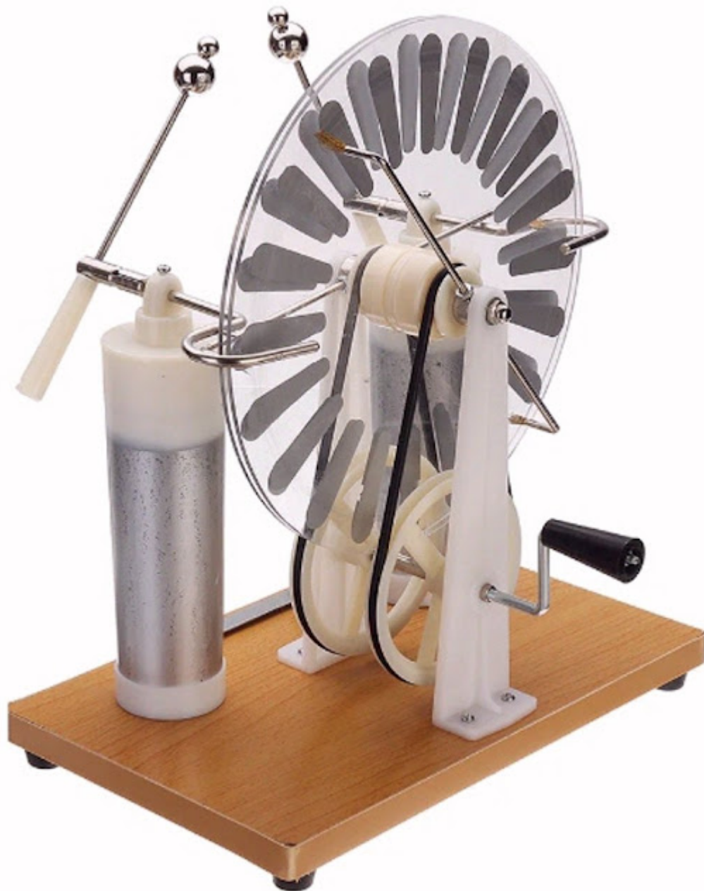
Een typisch voorbeeld van een Wimshurst machine. (© AliExpress)
